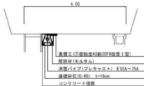
標準断面図(プレキャスト) S=1:50 (流雪溝隣接部)
